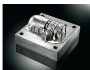
電動ドライバー(ヘッド部) 材料:マツウラスチール I
