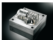
电动螺丝刀 (头部) 材质: 松浦产钢
